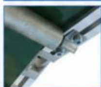
Направляющая и натяжной узел конвейерной ленты
